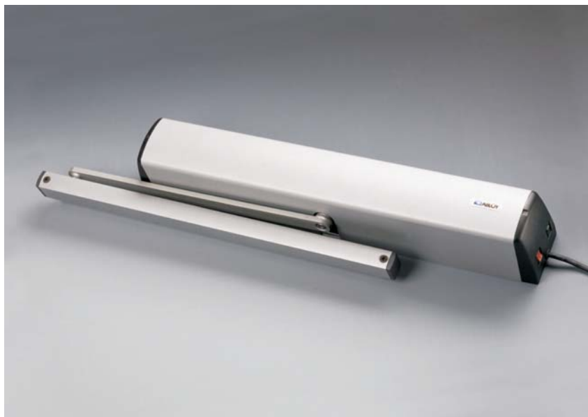
ABLOY DA460 – Operator cu electromotor, Clasa M – usa de greutate pana la 125 kg* * depinde de latimea usii (125 kg la 1000 mm latime cand se utilizeaza brat standard)
